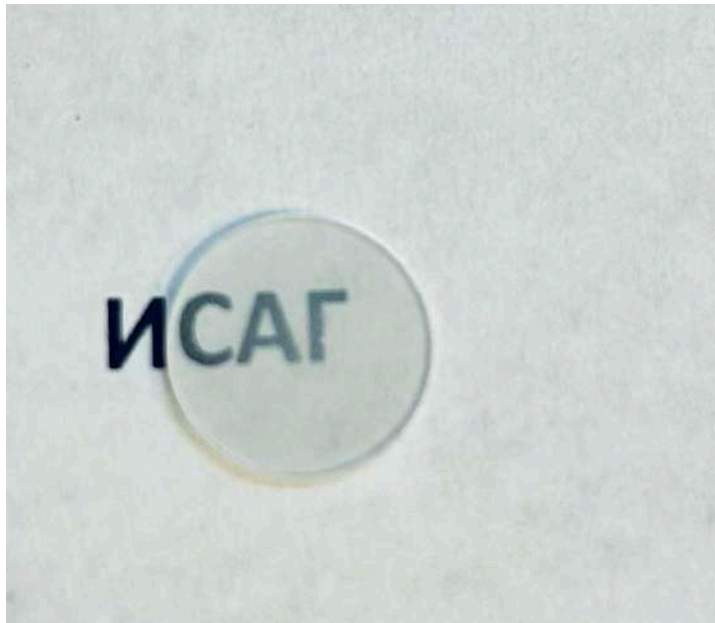
Рисунок 3.50 Образец прозрачной ИАГ керамики, модифицированной оксидом скандия, полученный из карбонатного прекурсора, синтезированного при 1250 °С при температуре 1700 °С
